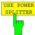
Der Softkey *USE POWER SPLITTER* aktiviert und deaktiviert die automatische Berücksichtigung eines Leistungsteilers, der das eingespeiste HF-Signal zwischen dem Leistungsmesskopf und dem HF-Eingang des R&S Analysators aufteilt.
