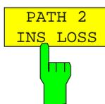
Der Softkey *PATH 2 INS LOSS* öffnet ein Dateneingangsfeld zur Definition der Einfügungsdämpfung des Leistungsteilers zwischen der Signalquelle und dem HF-Eingang des R&S Analysators. Dieser Wert wird bei Spektrum- und IQ-Messungen korrigiert.
