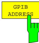
Der Softkey *GPIB ADDRESS* öffnet ein Dateneingangsfeld zum Einstellen der IEC-Bus-Adresse über den der externe Leistungsmesser für die Fernbedienung adressiert wird.
