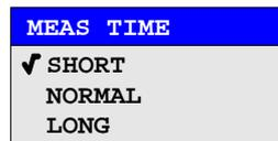
Stationäre Signale mit einer hohen Leistung ( $> -40\text{dBm}$ ) erfordern nur eine kurze Messzeit um stabile und genaue Ergebnisse zu erzielen. In diesem Fall ist die Einstellung *SHORT* zu empfehlen, da hiermit die höchsten Wiederholraten für die Messung erreicht werden.
