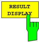
Der Softkey *RESULT DISPLAY* schaltet die Ergebnisdarstellung der Leistungsmessung ein bzw. aus. Falls die Darstellung ausgeschaltet wird, erfolgt die Anzeige der gemessenen Leistung im Marker-Info-Feld.
